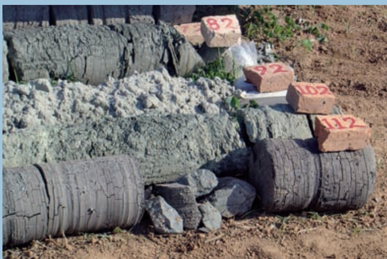
Taubaté (SP) – Rocha- testemunho retirado em perfuração de poço a diferentes profundidades. Foto: Hélio Nóbile Diniz.
